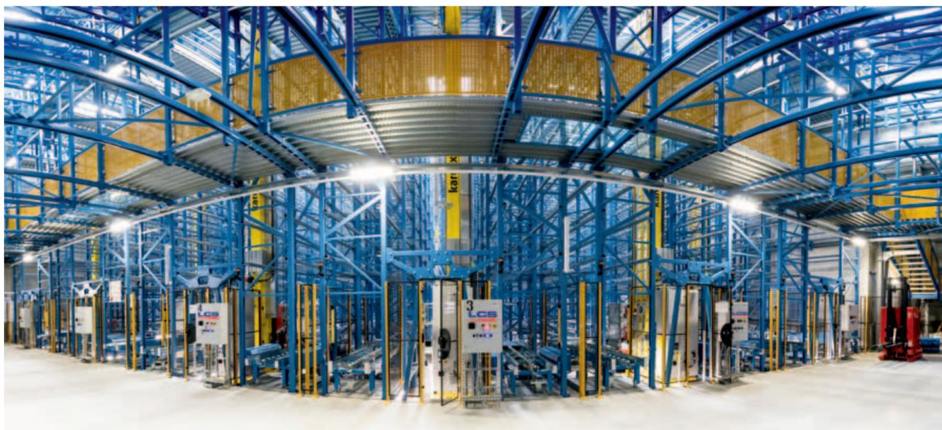
**Veduta frontale del magazzino automatico con trasloelevatori e carrelli LGV**
