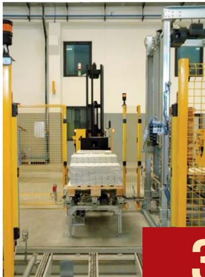
Il magazzino autoportante Growermetal misura 20 metri di altezza con 17 livelli di stoccaggio per una capacità complessiva di 5.500 europallet, con possibilità di allocare sia il pallet interi sia cassoncini e mezzi pallet per un totale di 11.000 locazioni
