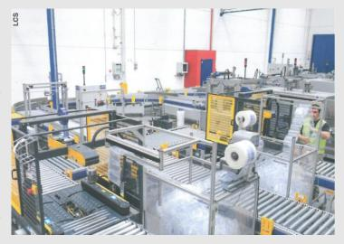
Una criticità incontrata nella fase di realizzazione dell'impianto, è stata la mancanza di un'area libera per svolgere le attività, ma grazie ad un piano dettagliato di montaggio condiviso con tutti gli attori del progetto, si è proceduto ad una implementazione a step, permettendo così al cliente di non dover interrompere le sue attività produttive.
