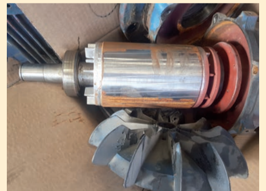
Gli effetti dell'ossidazione sui componenti
