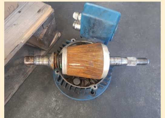
Un rotore compromesso dalla ruggine
