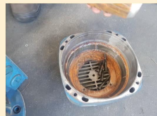
Gli effetti dell'ossidazione sui componenti
