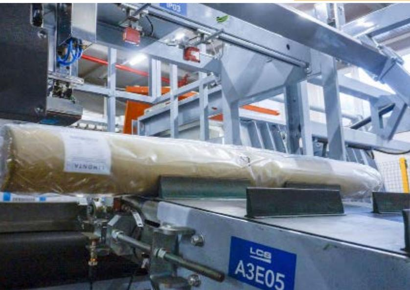
**La progettazione e realizzazione del nuovo sistema di picking collegato al magazzino automatico rinnovato ha rappresentato una sfida tecnologica, vista l'irregolarità delle dimensioni dei rotoli di tessuto e i flussi intensi**
